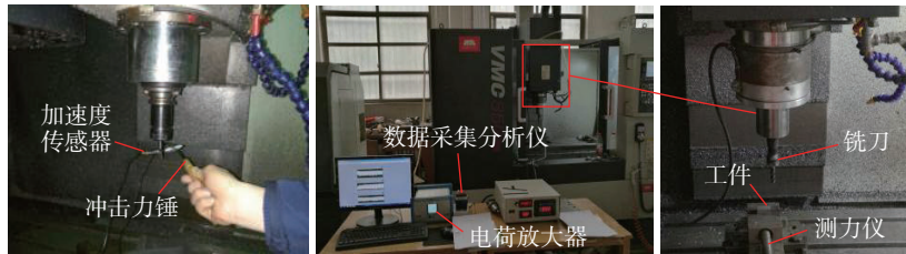
图9 扭转超声振动辅助铣削试验设备
